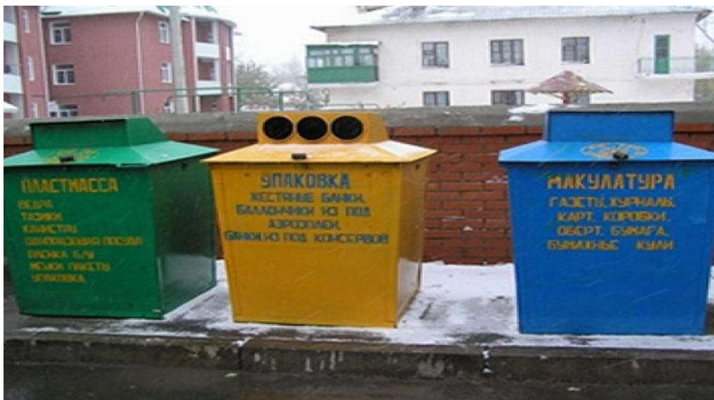
Рис. 4.6.1 – Контейнер К-0,75 с крышкой, доработанной для отдельного сбора отходов
